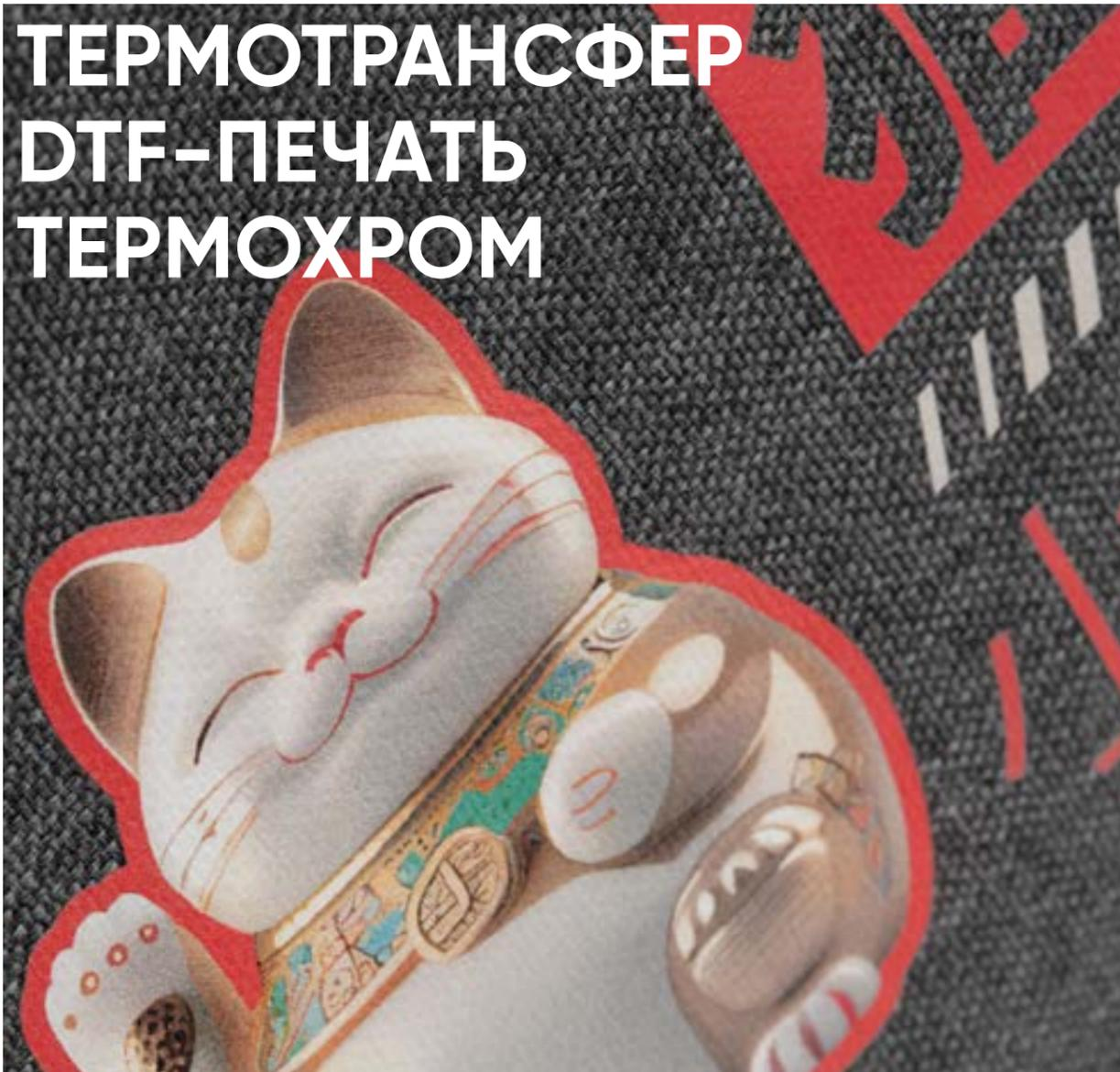
**Термотрансфер** – это метод переноса изображения на поверхность с использованием специальных промежуточных материалов и кратковременного (от 5 до 30 секунд) воздействия температуры от 120°C до 190°C. Технология позволяет переносить изображение практически на любую поверхность: от тканей до стекла. Благодаря таким уникальным свойствам, как износостойкость, стойкость к агрессивным средам, скорость печати – метод термотрансфер пользуется высоким спросом.
